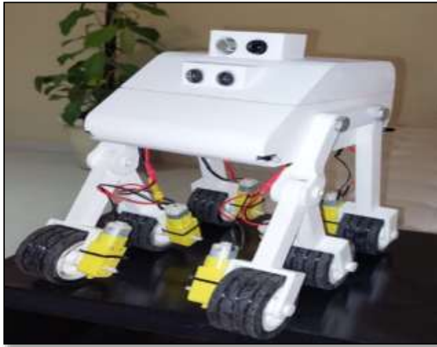
Figura 5: Ensamble final del vehículo. Fuente: Nieto y Tablante (2024)
