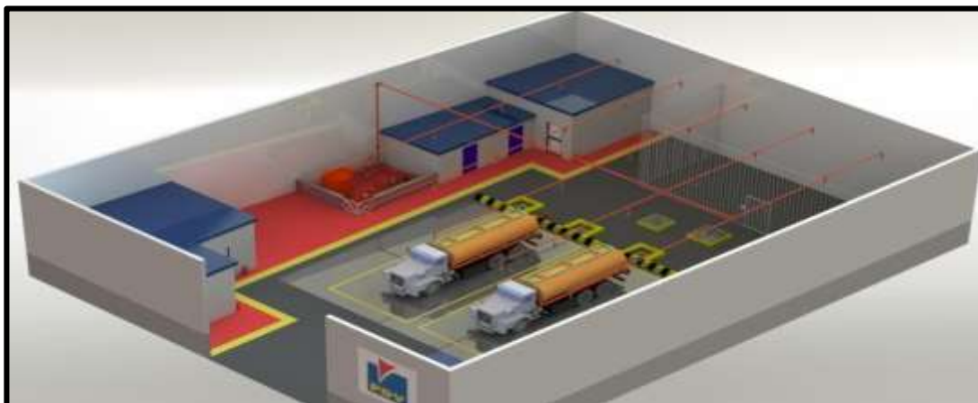
Figura 25: Sistema de protección contra incendio montado en la distribuidora el valle C.A. Fuente: Lara. J (2024)
